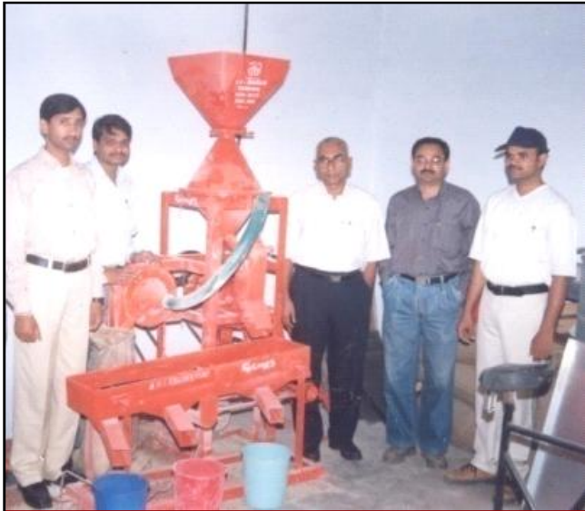
Fig. A : CFTRI Dal milling machine
