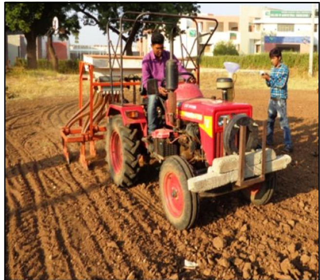
Fig. 1 : Mini tractor with front ballasting
