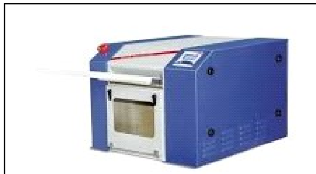
Fig. F : Cotton trash separator
